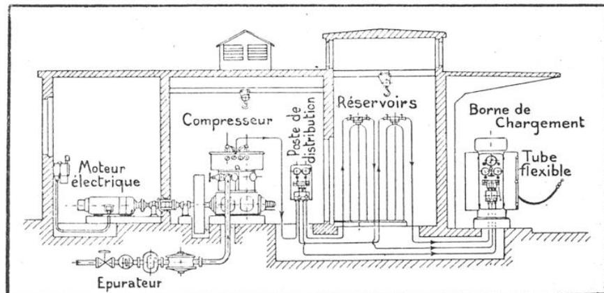
FIG. 11. — COUPE SCHÉMATIQUE D'UN POSTE DE COMPRESSION MODERNE
