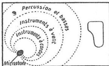
FIG. 9. — DISPOSITION DES INSTRUMENTS DE MUSIQUE ET DU MICROPHONE DANS UN STUDIO D'ENREGISTREMENT MUSICAL
