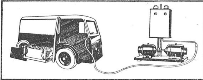
FIG. 3. — POSTE DE CHARGE POUR UNE CAMIONNETTE DE 1 000 KG
