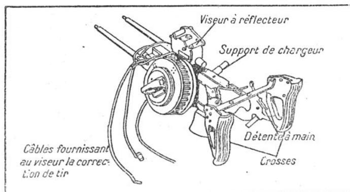
FIG. 6. — MITRAILLEUSES « AVIATION 34 » JUMELÉES DANS LA TOURELLE D'UN AMIOT 143.
