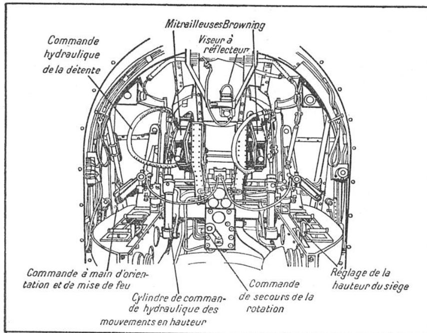
FIG. 10. — DÉTAILS DE L'INTÉRIEUR DE LA TOURELLE AVANT DU VICKERS WELLINGTON
