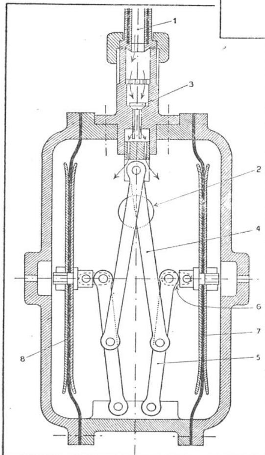
FIG. 6. — SCHÉMA DU DÉTENTEUR « TOUT GAZ »
