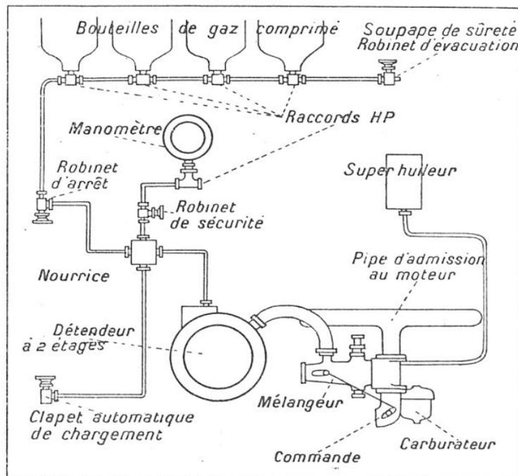
FIG. 1. — SCHÉMA DU MONTAGE DE L'APPAREILLAGE « GAZCO »
