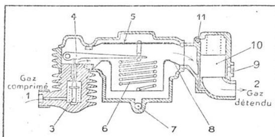
FIG. 8. — SCHÉMA DU DÉTENDEUR-DOSEUR AUTOMATIQUE L.E.M. ADOPTÉ PAR LES AUTOMOBILES LAFFLY
