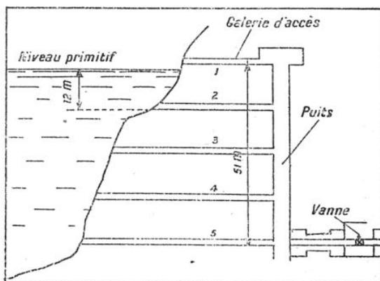
FIG. 4. — PERCEMENT DU LAC DE CAILLAOUAS PAR ABAISSEMENTS SUCCESSIFS DU PLAN D'EAU
