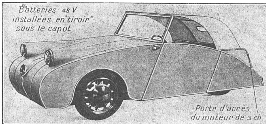
FIG. 6. — L'« ÉLECTRO-RENARD », VOITURE ÉLECTRIQUE LÉGÈRE DONT LA CONSOMMATION AUX 100 KM ATTEINDRA TOUT AU PLUS LA VALEUR DE 2 LITRES D'ESSENCE. La photographie ci-dessus montre le premier modèle de cette voiture avec châssis à trois roues. Le châssis à quatre roues est identique. Vitesse en palier : 35 km/h ; rayon d'action : environ 70 km.
