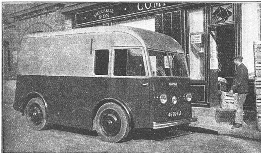
FIG. 4. — CAMIONNETTE POUVANT EMPORTER UNE TONNE DE CHARGE UTILE A UNE VITESSE DE 28 KM/H, AVEC UN RAYON D'ACTION DE 65 KM (SOVEL)
