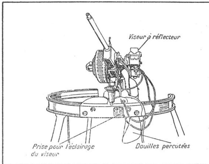
FIG. 5. — LE MONTAGE D'UNE MITRAILLEUSE « AVIATION 34 » SUR UN AMIOT 143
