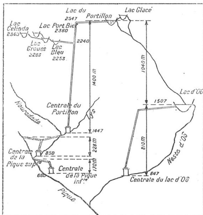
FIG. 3. — SCHÉMA DE L'ÉQUIPEMENT HYDROÉLECTRIQUE DE LA VALLÉE DE LUCHON
