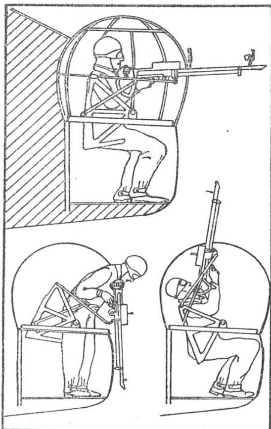
FIG. 13. — SCHÉMA D'UNE TOURELLE SIMPLE VICKERS (POUR ÉTAMBOT), ARTICULÉE, POUR TIRER DANS TOUS LES AZIMUTS
