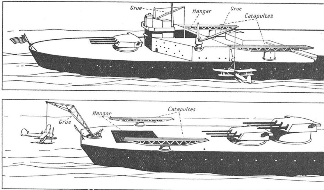
FIG. 5. — DEUX EXEMPLES D'INSTALLATION DE CATAPULTAGE SUR LES CROISEURS DE 10 000 T « ASTORIA » ET « NASHVILLE »
