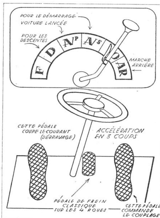
FIG. 2. — LES COMMANDES DE L'AUTOMOBILE ÉLECTRIQUE « STELA »
