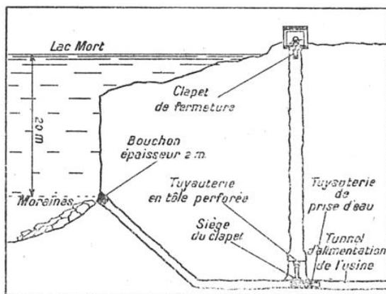
FIG. 9. -- PERCEMENT D'UN LAC AVEC CONTRE-PRESSION D'EAU
