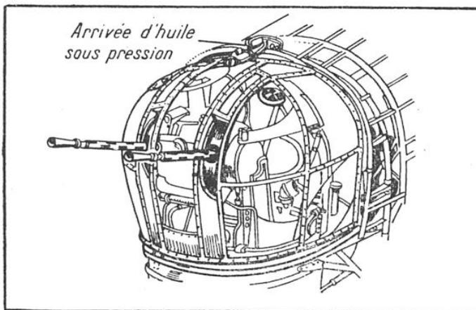
FIG. 9. — LA TOURELLE AVANT DU BOMBARDIER VICKERS WELLINGTON
