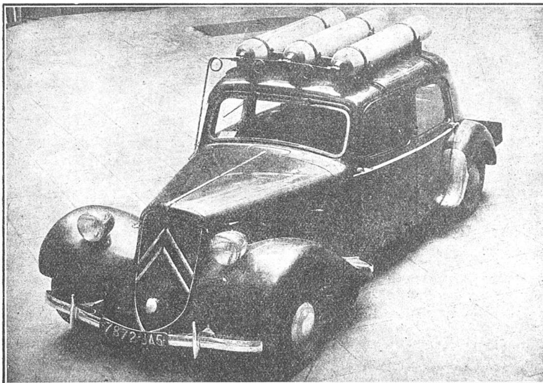
FIG. 1. — VOITURE CITROËN 11 CH LÉGÈRE ÉQUIPÉE AU GAZ D'ÉCLAIRAGE COMPRIMÉ
