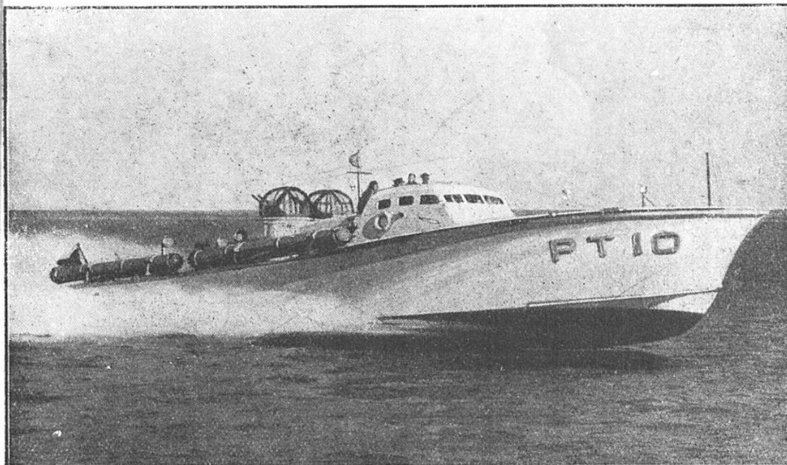
FIG. 9. — UNE DES NOUVELLES VEDETTES TORPILLEURS « MOSQUITOS » ARMÉES DE 6 TUBES LANCE-TORPILLES ET DE PLUSIEURS CANONS AUTOMATIQUES SOUS TOURELLES CAPABLES D'ATTEINDRE UNE VITESSE DE 80 KM/H (3 MOTEURS PACKARD DE 1 350 CH).
