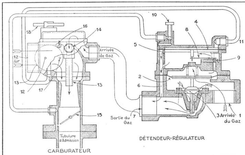
FIG. 10. — SCHÉMA DU DÉTENDEUR-RÉGULATEUR ET DU CARBURATEUR AMÉRICAINS « ENSIGN »
