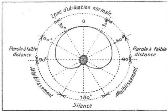
FIG. 8. — LE CHAMP D'ACTION DU MICROPHONE CARDIOÏDE
