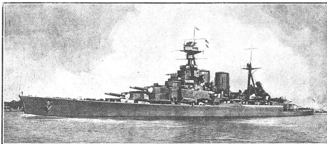
FIG. 6. — LE CROISEUR DE BATAILLE BRITANNIQUE « HOOD », DÉPLAÇANT 42 000 T ET ARMÉ DE HUIT CANONS DE 380 MM
