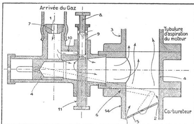
FIG. 7. — SCHÉMA DU MÉLANGEUR UTILISÉ AVEC LE DÉTENTEUR « TOUT GAZ »
