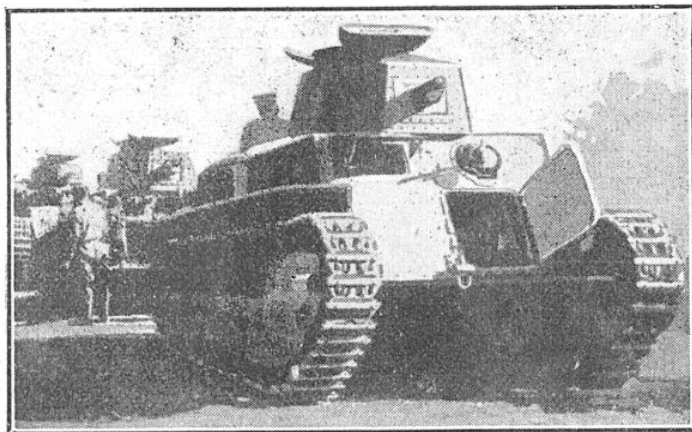
FIG. 4. — LE CHAR MOYEN M 94 (1934) DE 14 TONNES Ses caractéristiques principales sont : équipage, cinq hommes ; armement, un canon de 37 mm de tourelle, une mitrailleuse de tourelle, une mitrailleuse de côté ; capacité de franchissement, 3,1 m sur 0,9 m d'épaisseur ; vitesse, 45 km/h. Il gravit des pentes de 40° grâce à son moteur de 160 ch.
