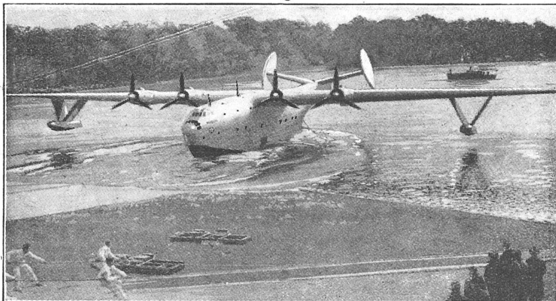
FIG. 5. — L'HYDRAVION GROS PORTEUR DE L'AVIATION NAVALE AMÉRICAINE MARTIN PB 2 M-1 « MARS » Cet appareil, unique réalisation du type jusqu'à présent, est équipé de quatre moteurs Wright « Duplex Cyclone », 18 cylindres de 2 000 ch. Il pèse en charge 64 t, dont 11 de charge utile, et peut emporter en particulier quatre torpilles de 1 500 kg et même un canot à moteur. Son envergure est de 61 m. Lors de ses essais, l'incendie d'un moteur provoqua de graves dommages qui seraient maintenant réparés.
