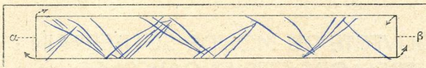
FIG. 1. — LE FENDILLEMENT D'UNE GLACE SOUS L'EFFET D'UN EFFORT DE TORSION (EXPÉRIENCE DE DAUBRÉE)
