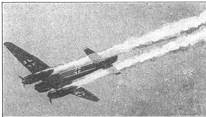
FIG. 1. — TOUT A FAIT EXCEPTIONNELLEMENT, LES CONDENSATIONS NUAGEUSES, QUI PRENNENT NAISSANCE LE PLUS SOUVENT A AU MOINS PLUSIEURS MÈTRES DERRIÈRE L'APPAREIL, PEUVENT SE FORMER IMMÉDIATEMENT DERRIÈRE LES MOTEURS, COMME ICI AVEC UN JUNKERS 88
