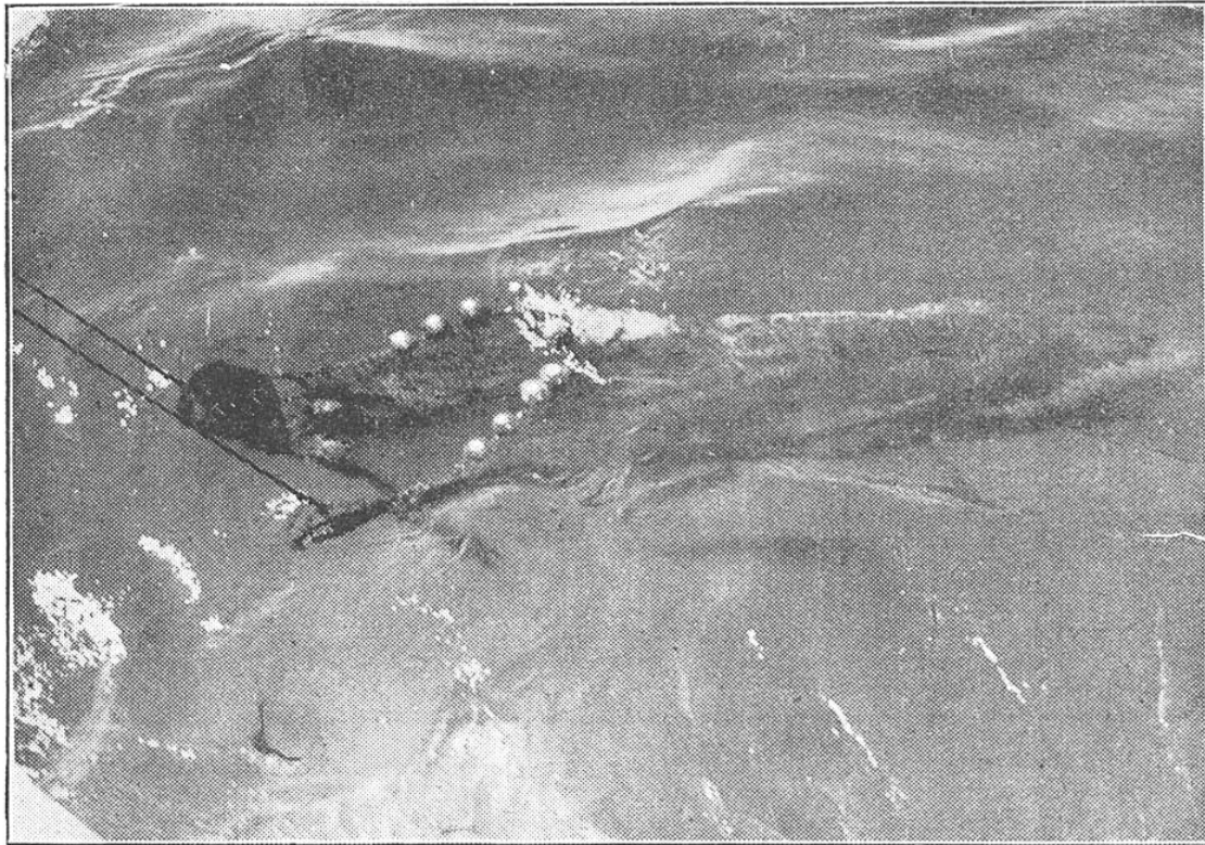
FIG. 6. — FILET A PLANCTON MIS A LA TRAINÉ ET MAINTENU OUVERT PAR DES FLOTTEURS EN VERRE
