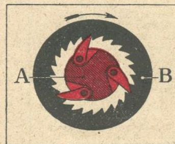
FIG. 10. — UN EMBRAYAGE DE SURMULTIPLICATION RÉALISÉ PAR UNE ROUE LIBRE À CLIQUETS
