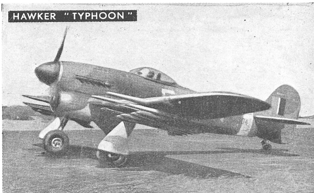
Le Hawker « Typhoon » est un avion à moteur Napier « Sabre » de 24 cylindres en H, donnant plus de 2 200 ch. Sa vitesse dépasse 650 km/h et son plafond 12 000 m. C'est le premier avion allié qui ait été employé en grande série comme lance-fusées, ce qui lui a valu des succès remarquables, notamment l'an dernier, en Normandie, contre les chars allemands. En chasseur, l'appareil porte soit 12 mitrailleuses de 7,7 mm, soit 8 mitrailleuses de 12,7 mm, soit 4 canons de 20 mm. En lance-fusées, il porte 4 canons de 20 mm et 8 fusées chargées chacune à 27 kg d'explosif. En bombardier, il porte 4 canons de 20 mm et 2 bombes de 450 kg.
