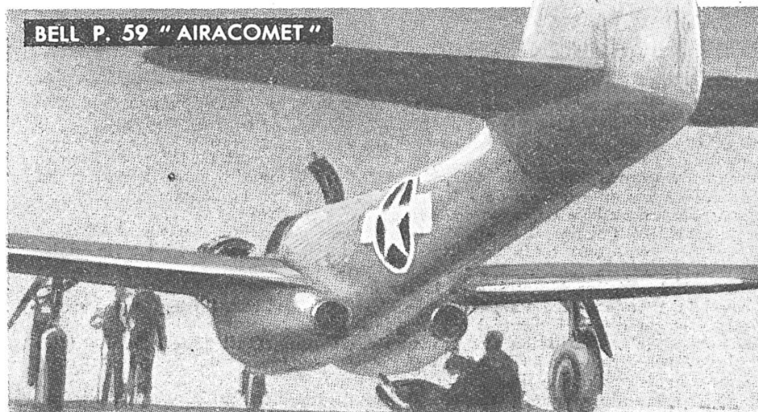
Le Bell P-59 « Airacomet » est le premier avion à réaction construit aux Etats-Unis; il est mû par deux propulseurs construits, sur les plans anglais Whittle, par la General Electric Co.
