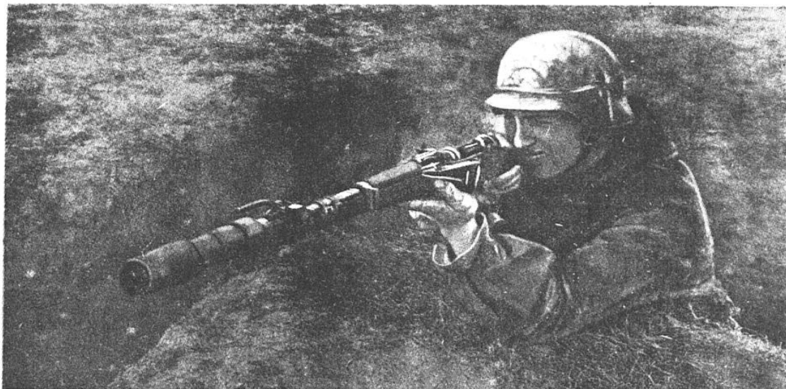
FIG. 11. — D'UNE PORTÉE MAXIMUM DE QUELQUE 200 M, CETTE GRENADE ALLEMANDE A CHARGE CREUSE TIRÉE PAR UN FUSIL SERVAIT CONTRE LES CHARS
