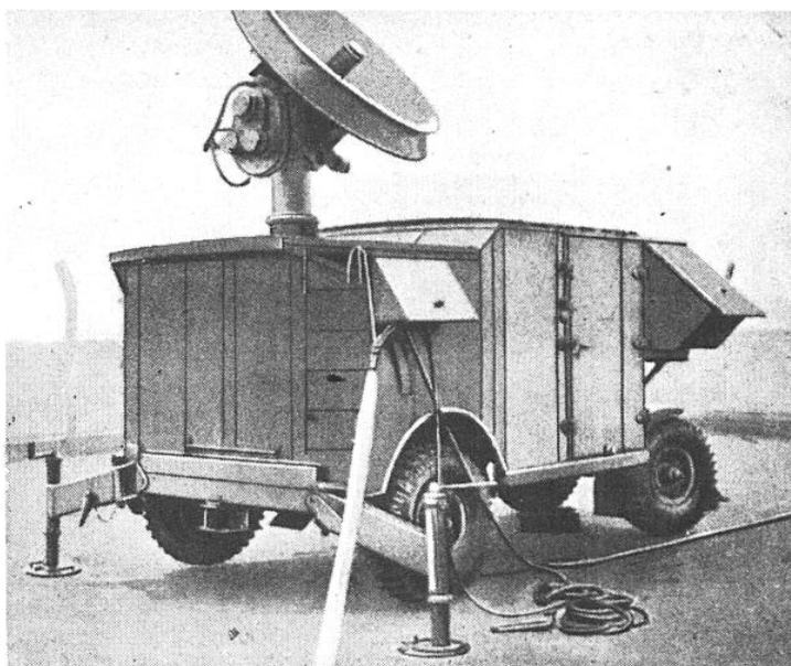
FIG. 13. — UN RADAR TÉLÉMÉTRIQUE SERVANT AU RÉGLAGE DE TIR DE D. C. A.
