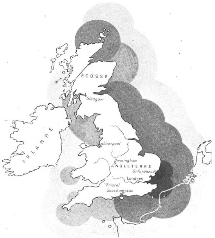
FIG. 9. — LE DÉVELOPPEMENT PROGRESSIF DE LA CHAÎNE PROTECTRICE DE STATIONS RADAR LE LONG DES CÔTES ANGLAISES
